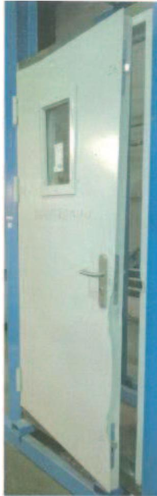
Vue de porte après l'essai de l'effraction manuelle du côté de la serrure - côté ouverture
