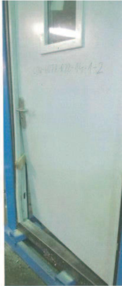
Vue de porte après l'essai de l'effraction manuelle du côté de la serrure - côté fermeture
