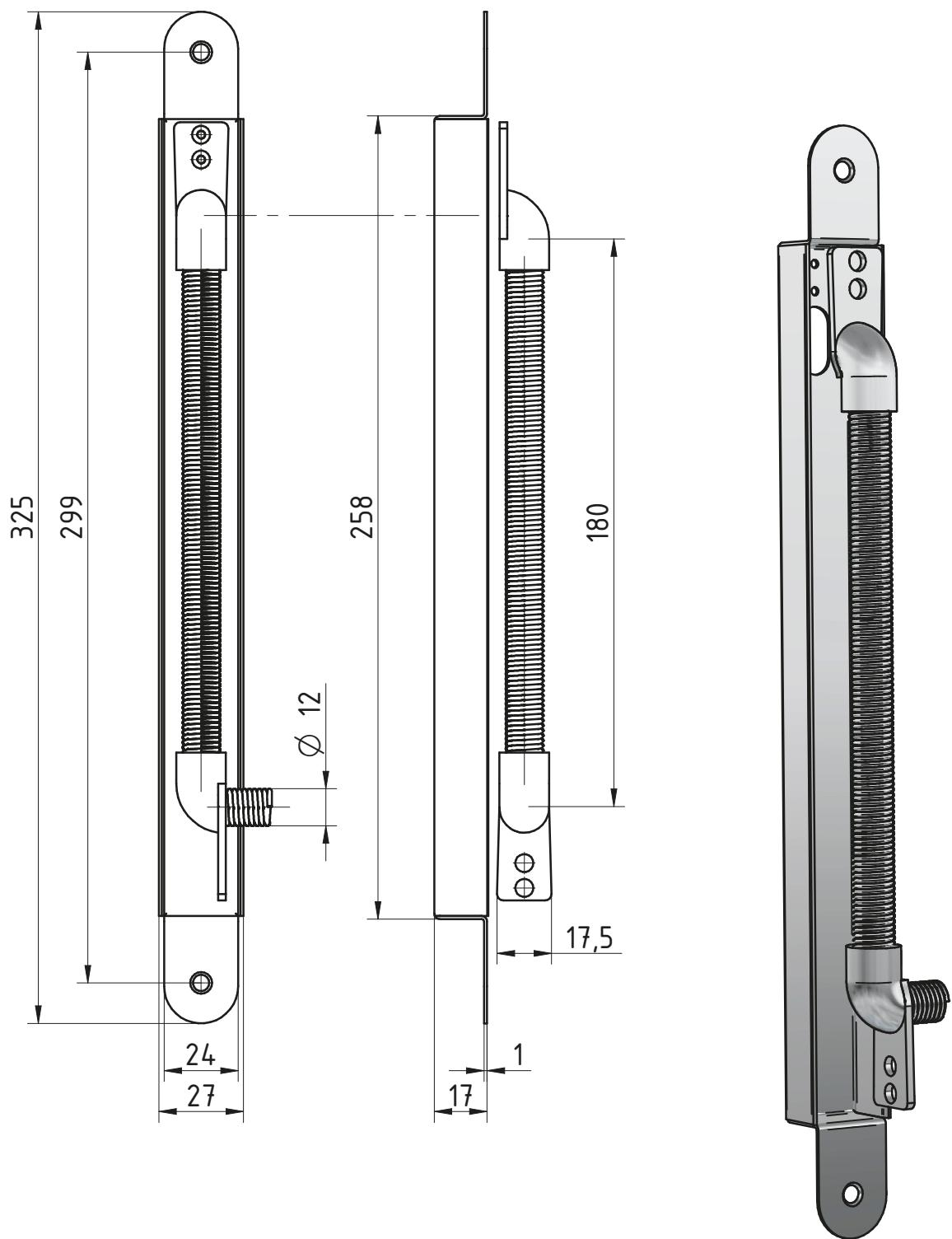
diamètre maximal du câble: 7,5 mm
