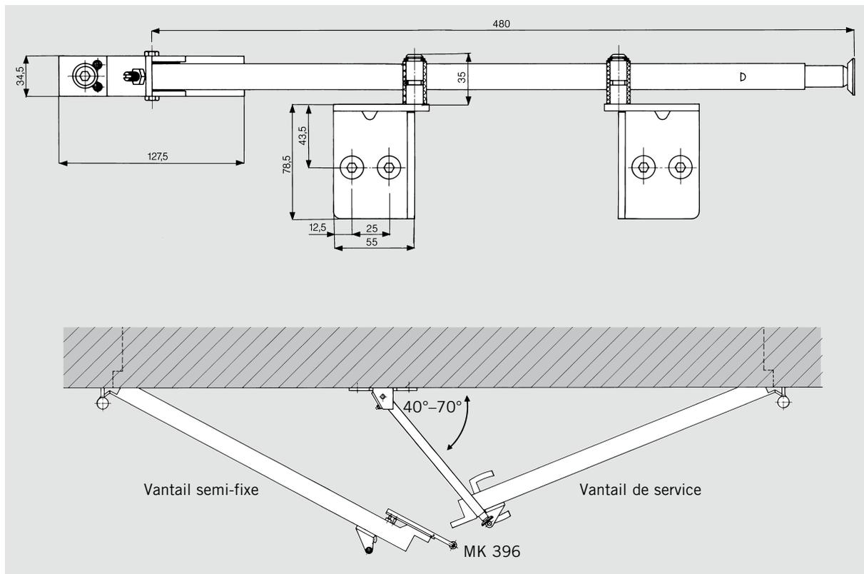
**Le DORMA SR 390 est un sélecteur mécanique pour portes coupe-feu à deux vantaux.**
